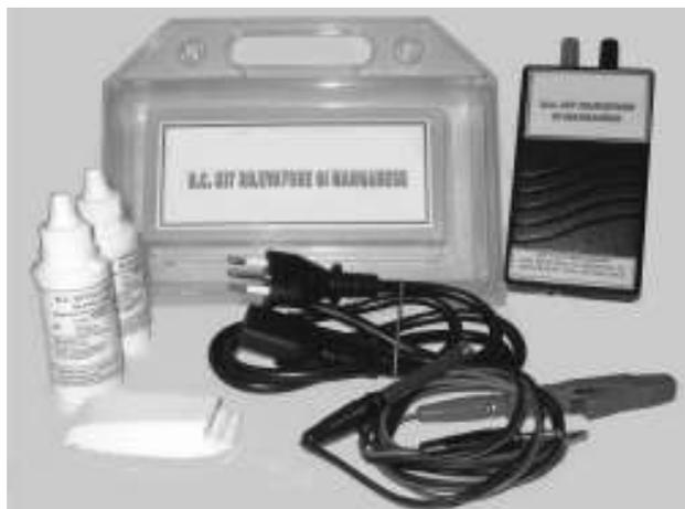
*Nota: il presente metodo permette di fare un'analisi qualitativa e non può dare una risposta precisa in termini di concentrazione; tuttavia dalle prove effettuate risulta chiara la distinzione tra le leghe AISI 304/316 e le leghe AISI 201/202*
